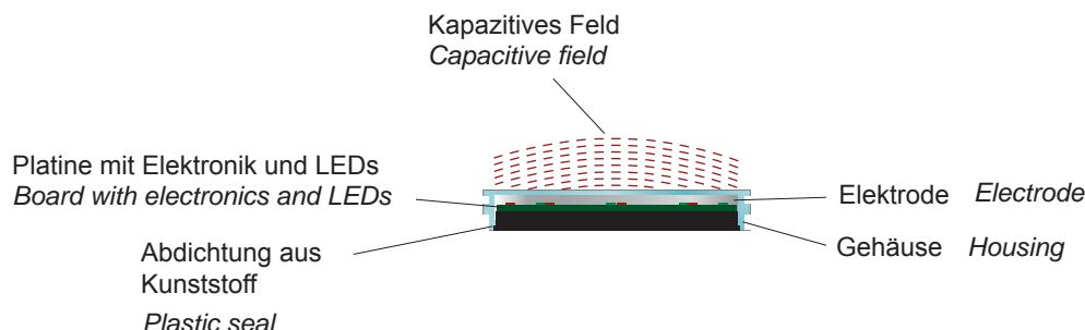
Da der Mensch zum größten Teil aus Wasser besteht, hat der menschliche Körper auch eine relativ hohe Leitfähigkeit. Deshalb eignen sich Sensoren nach dem kapazitiven Prinzip besonders gut als SENZORtaster.
